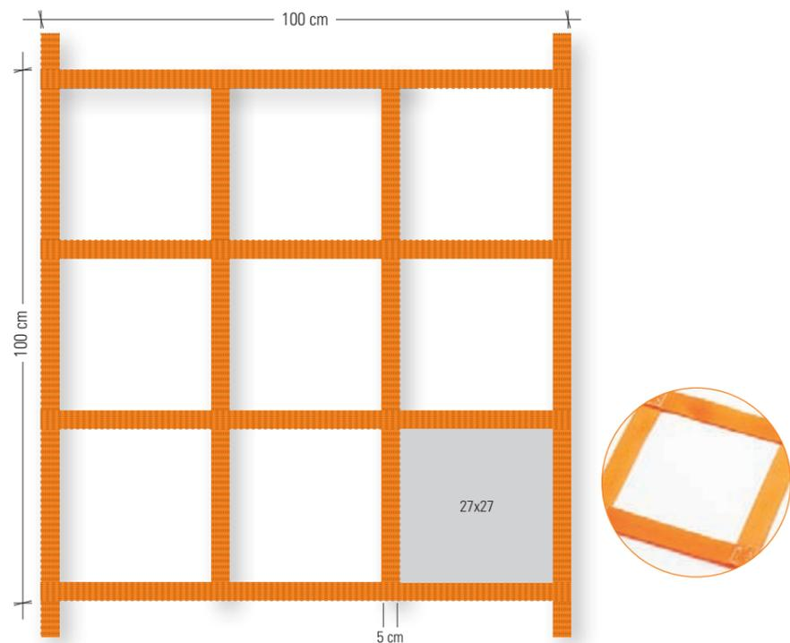
• Red de sujeción de cargas fabricada en poliéster de alta tenacidad, en cinta de 50 mm (7.500 kg rotura). Cierre carraca sin fin con cinta perimetral para tensar o anclar según el lugar de colocación (tensor carraca sin fin incluido). EN 12195-2 VDI 2700 BI. 3.3
