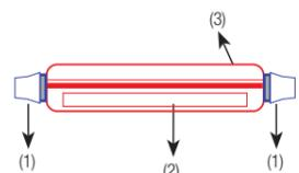
Equipo de Protección Individual textil fabricado con el único fin de reducir el impacto o golpe seco que genera el frenado de la caída.
