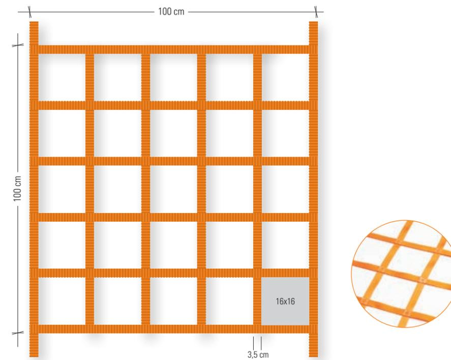
• Red de sujeción de cargas fabricada en poliéster de alta tenacidad, en cinta de 35 mm (3.500 kg rotura). Cierres de hebilla de presión para tensar o anclar según el lugar de colocación. **EN 12195-2 VDI 2700 BI. 3.3**
