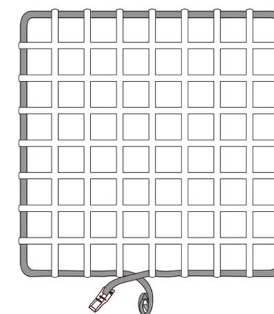
Se presentan los modelos estándar en cinta de 35 mm para cierre con hebillas o cierre con cinta perimetral y carraca sin fin. Las redes de amarre de carga se pueden fabricar a medida y con la combinación de componentes que se adapten a sus necesidades (Ver pág. 63). Consulte en fábrica posibles combinaciones.
