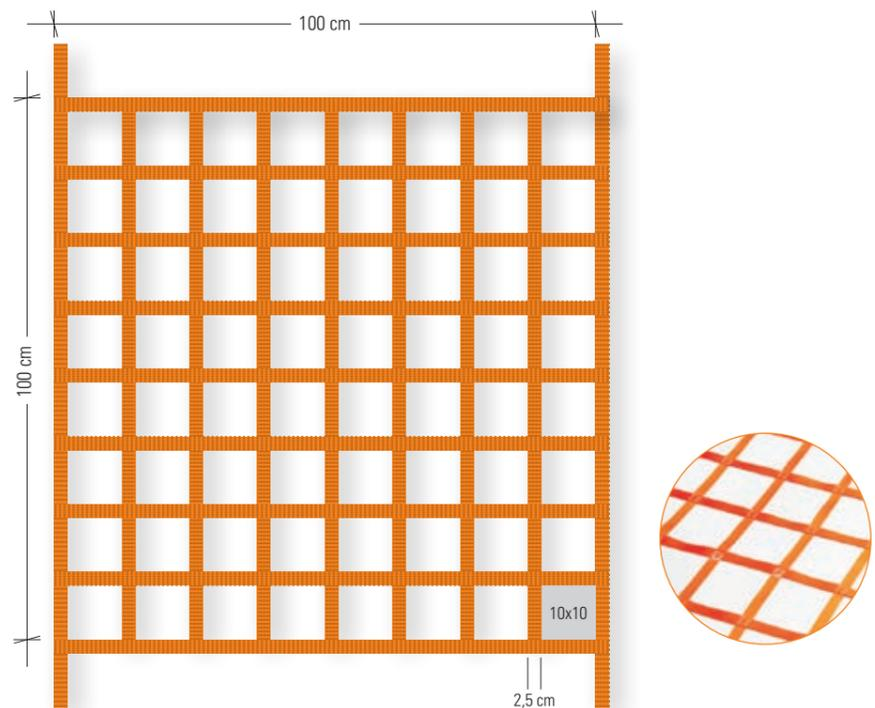
• Red de sujeción de cargas fabricada en poliéster de alta tenacidad, en cinta de 25 mm (1.500 kg rotura). Cierres de hebilla de presión para tensar o anclar según el lugar de colocación. **EN 12195-2 VDI 2700 BI. 3.3**
