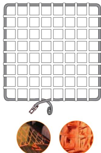
Se presentan los modelos estándar en cinta de 25 mm para cierre con hebillas o cierre con cinta perimetral y carraca sin fin. Las redes de amarre de carga se pueden fabricar a medida y con la combinación de componentes que se adapten a sus necesidades (Ver pág. 63). Consulte en fábrica posibles combinaciones.
