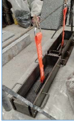
Proceso de fabricación de probetas de hormigón con anclajes AZ-950-3 embutidos
