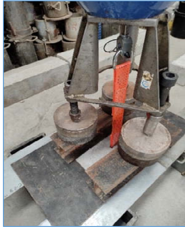
Proceso de fabricación de probetas de hormigón con anclajes AZ-950-3 embutidos
