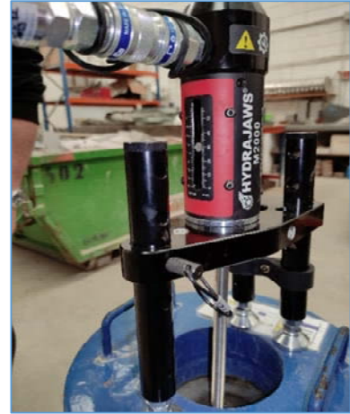
Proceso de fabricación de probetas de hormigón con anclajes AZ-950-3 embutidos
