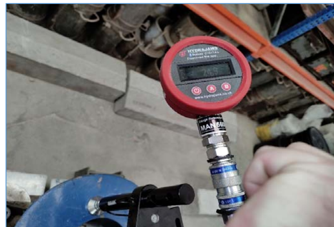
Ensayo de tracción "pull out" de anclajes
